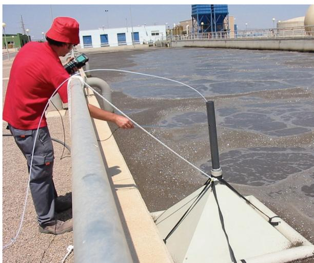
Fotografía 2.1.2.3. Toma de olores en emisión mediante cámara de flujo (cámara de flujo).
