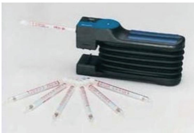
Figura 2.3.1.3. Tubos de adsorción y bomba personal de muestreo.
