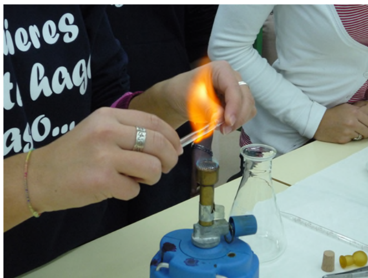
Figura 20. Construcción de una campana de Durham a partir de una pipeta Pasteur de vidrio en el mechero Bunsen por parte de un grupo de alumnos de 4º curso de Educación Secundaria.
