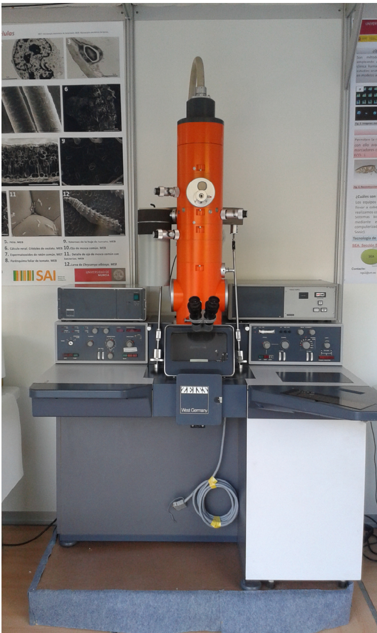
Figura 11. Microscopio electrónico de transmisión utilizado en la observación de la ultraestructura celular.
