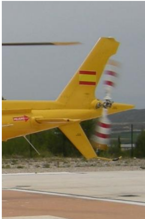
Ilustración 2: Rotor de cola (zona de extremo peligro).
