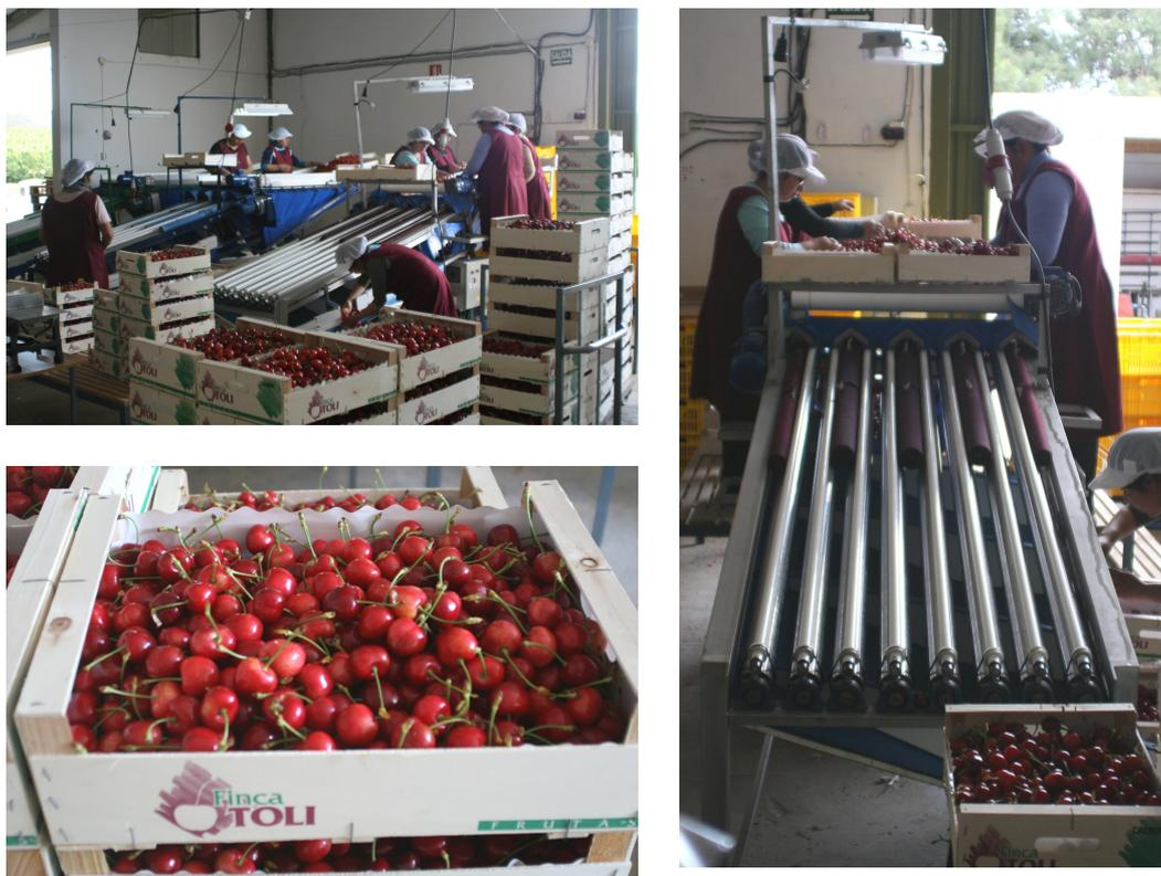
Figura 19.- A) nave de acondicionamiento de cereza. B) detalle de calibradora de cereza desarrollada en la finca Toli. C) Variedad *S-57* de gran calibre, recogida el 30 de Mayo de 2008.
