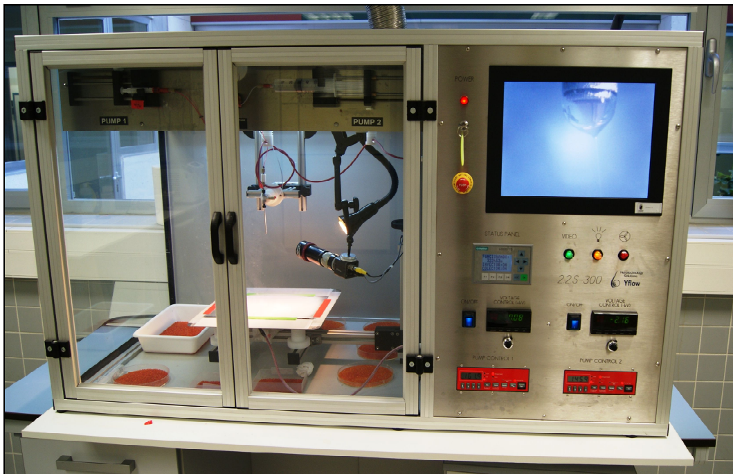
Figura 5.1. Equipo de electrohilatura Yflow™ 2.2.S-300 Electrospinner.
