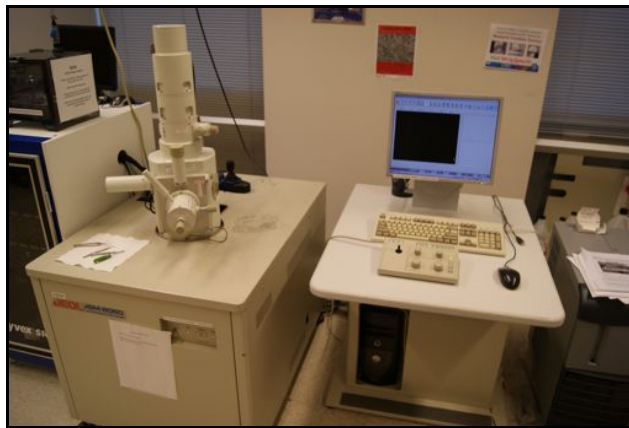
Figura 4.6. Microscopio electrónico de barrido Jeol-JSM-6060 ubicado en las instalaciones del ISN ("Institute for Soldier Nanotechnologies", Boston, EE.UU)
