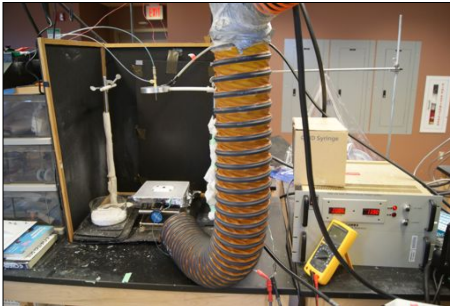
Figura 4.4. Equipo de electrohilado empleado para la elaboración de las mallas de fibroína de seda extraída con distintos protocolos, ubicado en las instalaciones del ISN ( Institute for Soldier Nanotechnologies , Boston, EE.UU).
